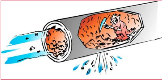
Abb. 2: Bei Enthärtung mit gewöhnlichem Ionenaustauscherharz wird die Leitfähigkeit erhöht, was Lochkorrosion begünstigt.
